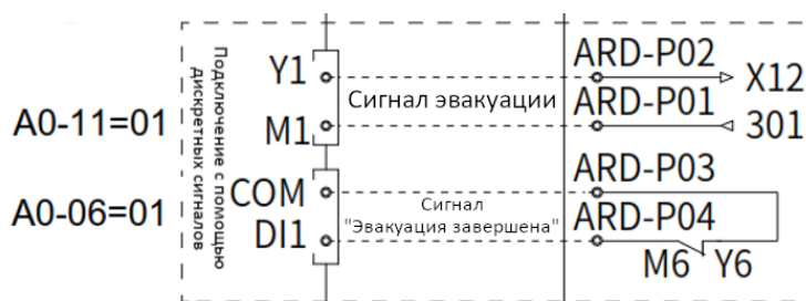
Рис.4.2 Подключение сигнала ARD
